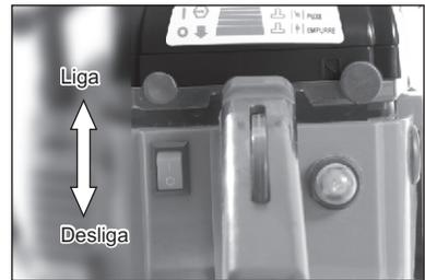
2. Pressione a trava do acelerador para liberar o gatilho e em seguida pressione o gatilho para que o motor permaneça em posição de arranque.
