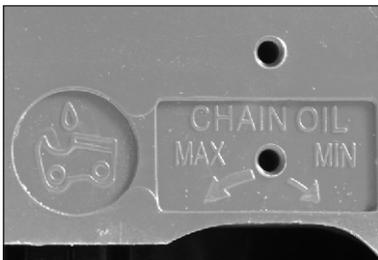
Ajuste o fluxo de acordo com suas necessidades de trabalho (o corte de madeira seca necessita de mais óleo).
